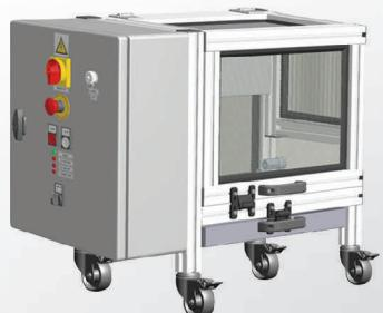
Клепальные головки и пневматико-гидравлический агрегат.
